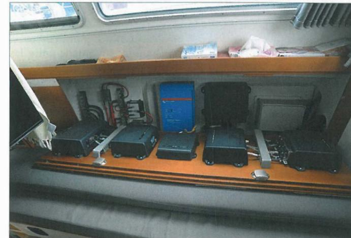
L'équipement électronique du bord est très complet avec notamment /es modules sondeur black box DFF3D et BBDS1, le module PBG, un transpondeur AIS FASO, un compas satellitaire SC30, un pilote automatique FP700 et un radar DRS4A et une caméra FLIR M200.
